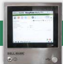
Die erweiterte HMI verfügt über einen 264-mm-Touchscreen und die Schutzart IP-67 für den Einsatz in rauen Umgebungen.
